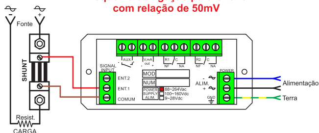
Esquema de ligação para Shunt com relação de 50mV
